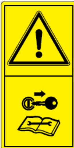
**Vor Wartungs- und Reparaturarbeiten Motor abstellen und den Schlüssel abziehen!**
